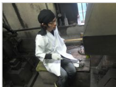
左手でホドについている棒を押ししたり引いたりすることで風を送り、温度を上げる
