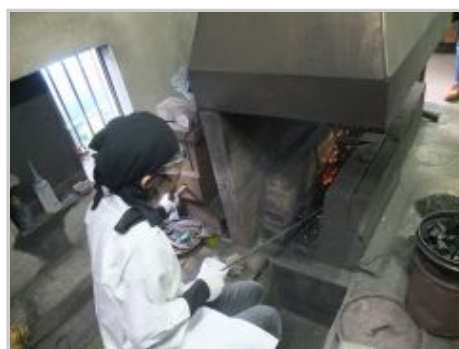
左手でホドについている棒を押ししたり引いたりすることで風を送り、温度を上げる
