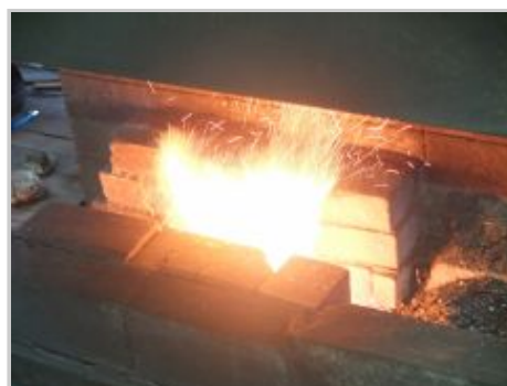
左手でホドについている棒を押ししたり引いたりすることで風を送り、温度を上げる
