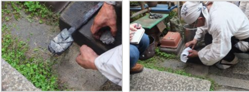
同質の素材の土台に心鉄／皮鉄をバランスよく置いて、紙で固定する
