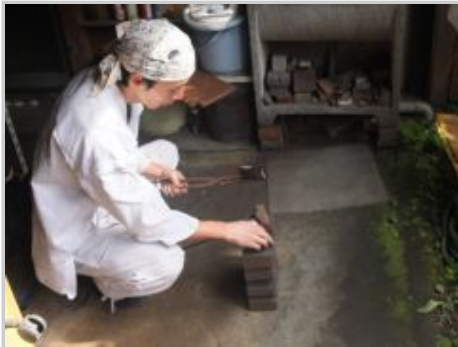
打ち延ばした玉鋼を小割にする
