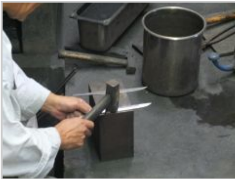
ひずみを取る;鍛冶研ぎ
